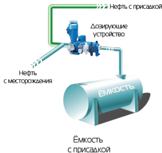
Рис. 1. Схема установки ввода присадок в транспортируемую среду
